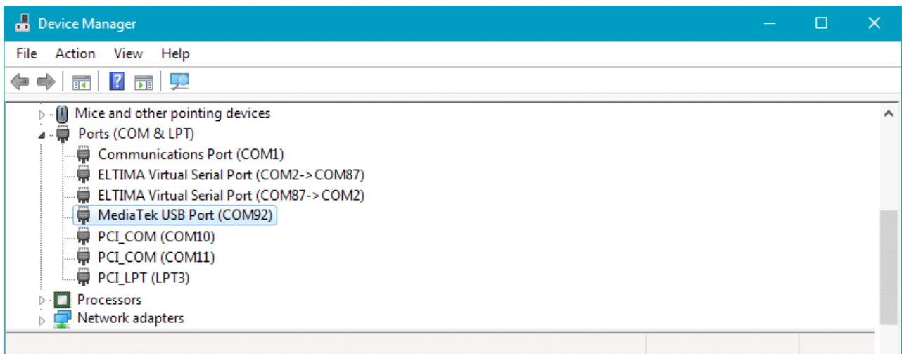
Рис. 21 Устройство с процессором MTK в режиме EDL, подключенное по USB
